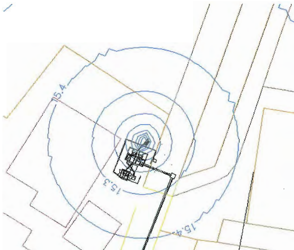
Figuur 7.2 Isohypsen [m + NAP] in een situatie uitgaande van een gemiddelde grondwaterstand (15,6 m + NAP) en een bemalingsduur van 2 weken.
